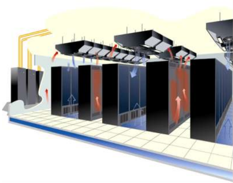
图表 31 机房顶部加制冷终端形式
